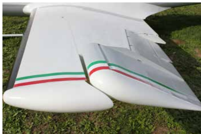
Particolarissimo l'alettone con il grosso compensatore soffiato e una fence separatrice di flusso
