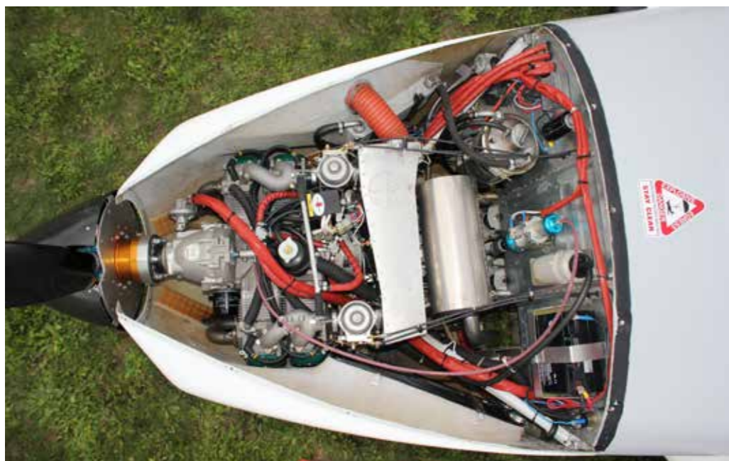
Nel vano motore il Rotax quasi si perde, si notano le prese laterali per i radiatori con i convogliatori e l'assenza di prese dinamiche frontali per i cilindri
